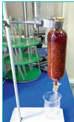
Сурет 1- Түктесін сіркеағаш ( Rhus tyrhina L.) дәрілік өсімдік шикізатын перколяциялау процесі
