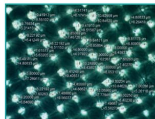
Рисунок 7 - Визуальное изображение структуры хлопчатобумажной ткани 187п-240 и его размер пор.
