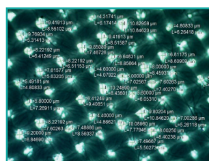
Рисунок 7 - Визуальное изображение структуры хлопчатобумажной ткани ГВО 187п-240 и его размер пор.
