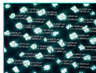
Рисунок 6 - Визуальное изображение структуры хлопчатобумажной ткани ГВО 4799-170 и его размер пор.
