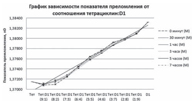
Рисунок 2 - Показатель преломления nD для бинарных растворов тетрациклин-аддукт иода при 20 °С
