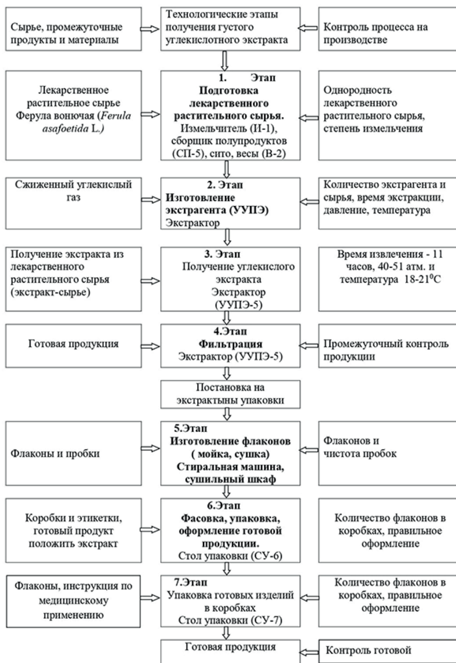
Рисунок 2 - Технологическая схема углекислотного экстракта, полученного из подземной части ферулы воночей ( Ferula asafoetida L. ) в докритических условиях
