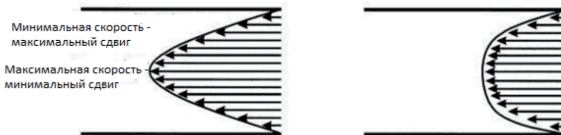
Рисунок 1 - Текущую кровь можно представить, как бесконечное число независимых слоев, скользящих друг по другу. На этом рисунке скорость слоя пропорциональна длине стрелки. Скорость сдвига определяется как разница скоростей между любыми двумя слоями, деленная на расстояние между ними. В жидкости с низкой вязкостью (слева) градиент скорости больше, чем в жидкости с высокой вязкостью (справа).
