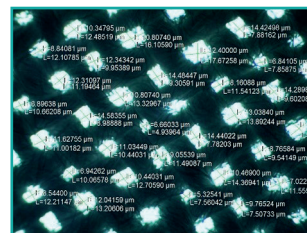
Рисунок 6 - Визуальное изображение структуры хлопчатобумажной ткани ГВО 4799-170 и его размер пор.
