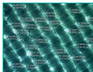
Рисунок 3 - Визуальное изображение структуры хлопчатобумажной ткани 5427-165 и его размер пор.
